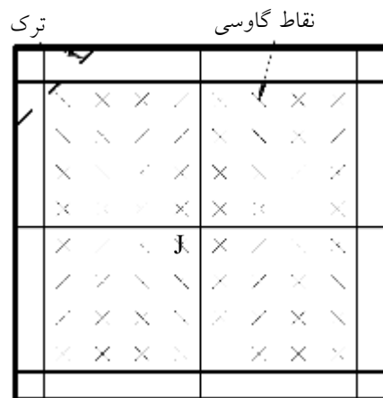
شکل ۴-۶. در دو طرف ترک نقاط گاوسی متعلق به حوزهٔ تاثیر گره J وجود دارد و آن گره باید با تابع تعمیم یافتهٔ هویساید غنی-سازی شود.
