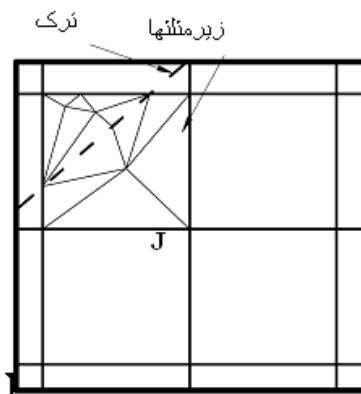
شکل ۳-۸: تقسیم‌بندی المانهای درگیر با ترک به زیرمثلث جهت انتگرال‌گیری [۲۵].
