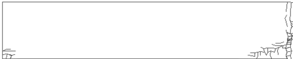
شکل ۲۰: نمایش میزان ترک خوردگی تیر در گام زمانی t=0.00174s
