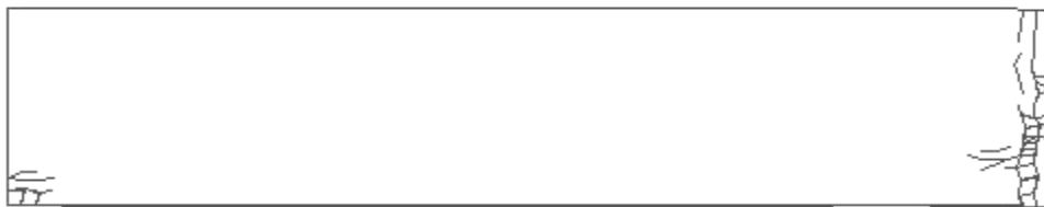
شکل ۱۹: نمایش میزان ترک خوردگی تیر در گام زمانی t=0.00165s
