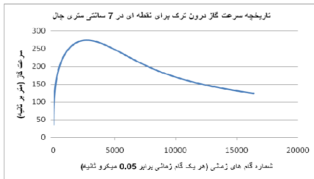
شکل ۴- نمودار سرعت گاز در نقطه شاهد تا ۹۰۰ میکرو ثانیه بعد از انفجار.
